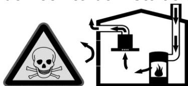
Los equipos calefactores que dependen del aire del recinto de instalación (p. ej., calefactores de gas, aceite, madera o carbón, calentadores de salida libre, calentadores de agua) adquieren aire de combustión del recinto de instalación y evacuan los gases de escape al exterior a través de un sistema extractor (p. ej., una chimenea).
