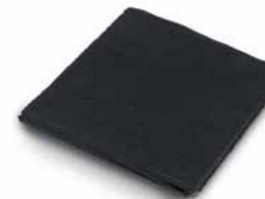
Filtro regenerable en espuma de poliuretano, recubierta de carbón activo granular e insertada en una malla de poliamida negra (nylon). Se obtiene una reducción de los olores del 60%. Se debe regenerar el filtro cada 2-3 meses lavándolo en lavavajillas o a mano y secándolo en horno a 60° durante 60 minutos. Se debe sustituir cada 2-3 años.
